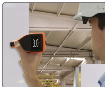
Automatické otáčanie displeja o 360° umožňuje dobrú viditeľnosť pri meraní v akomkoľvek uhle vo výrobe aj v laboratóriu.
